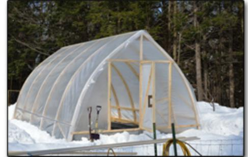
La plus grande difficulté rencontrée fut l'ouverture dans le toit pour l'aération. Il m'a fallu transformer un ancien moustiquaire fait en aluminium (plus léger que le bois) pour que le cylindre hydraulique puisse procéder à l'ouverture lorsque la chaleur devient trop élevée. La première serre fut inaugurée à la fin février et m'a permis de faire quelques récoltes depuis: laitues, radis, herbes.
